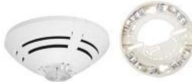
**Opis uređaja:** T 802171, Esser je termomaksimalni detektor požara serije IQ8quad. Detektor se koristi za otkrivanje požara sa velikim razvojem topote. Detekcija požara sa velikim razvojem topote ostvaruje se korišćenjem termičkog prekidača s fiksnom preklopnom temperaturom. Pogodni su za prostore u kojima se u normalnom radu pojavljuje dim ili slični aerosoli (na koje bi detektori dima reagovali), ali će kod požara kod kojih se razvija izuzetno visoka temperatura izvršiti alarmiranje.
